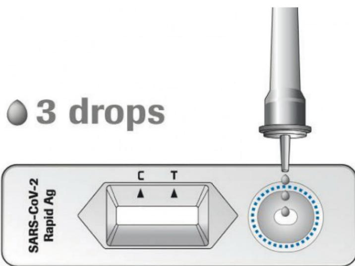
Drei Tropfen der zu testenden Probe werden auf die vorgesehenen Probenaufnahmen gefüllt.
